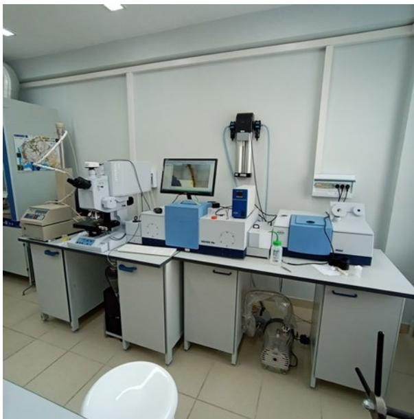
**Рис. 1.** ИК-Фурье спектрометр Vextex 70V с подключенными ИК-микроскопом HYPERION 3000 (слева) и камерой химической визуализации (IMAC) (справа).
