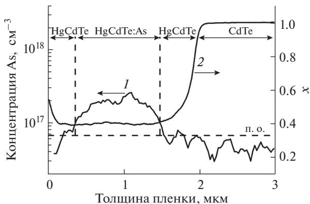
**Рис. 2.** Распределение концентрации As (1) и состава (x) (2) по толщине слоев  $\text{Hg}_{1-x}\text{Cd}_x\text{Te}$  (310) (поток ТДМАА –  $5 \times 10^{-7}$  моль/мин, ДЭТ/ДМК = 4.4 во время роста подслоя CdTe).
