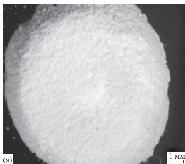
Рис. 4. Фотографии композиционного материала на основе альгината натрия с содержанием наполнителя 20%: t_{\text{сушки}} = 200 (а), 400^\circ\text{C} (б).
