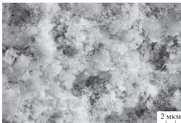
Рис. 8. Микрофотография (СЭМ) высокопористой керамики на основе РСНК ( P_o = 52\% ).
