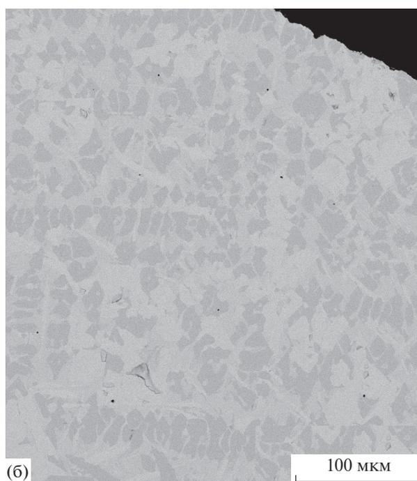
**Рис. 4.** Микроструктура сечения гафнийсодержащего образца после окисления в потоке плазмы: а – окисленный слой, б – СЭМ-снимок сечения образца в режиме обратнорассеянных электронов.
