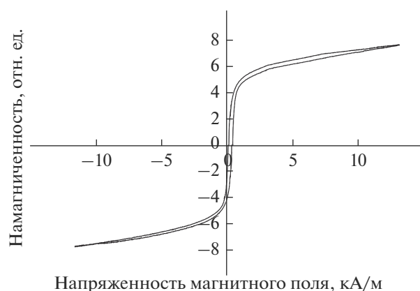
Рис. 5. Полевая зависимость намагниченности образца \text{YCo}_{0.2}\text{Fe}_{0.8}\text{O}_3 .
