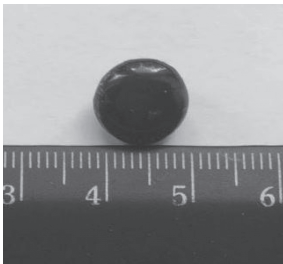
Рис. 1. Фотография стекла состава (\text{Ga}_2\text{S}_3)_{0.80}\text{--}(\text{Sm}_2\text{S}_3)_{0.10}(\text{EuS})_{0.10} .
