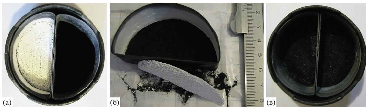
**Рис. 1.** Тигли с реакционной массой после восстановления вольфрамов  $MgWO_4$  (а, б) и  $Ca_3WO_6$  (в); содержание фосфора в вольфрамите: 0.05 мас. % (левые контейнеры а и в, контейнер б), 0.4 мас. % (правый контейнер а), 0.6 мас. % (правый контейнер в) (остаточное давление аргона в реакторе 10 кПа, температура в объеме реактора 730°C).
