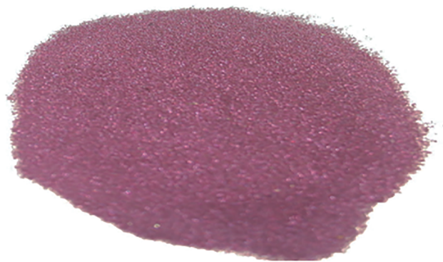
Рис. 2. Фотография полученного порошка гексаборида лантана.
