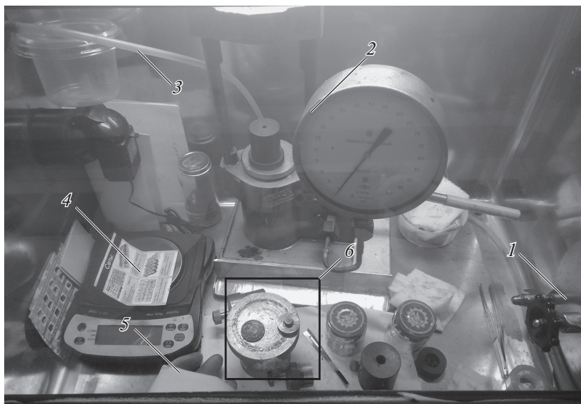
Рис. 1. Общий вид установки для получения компактных образцов внутри герметичного бокса: 1 – шлюз, 2 – пресс, 3 – выход на анализатор кислорода, 4 – цифровые весы, 5 – перчатки, 6 – набор пресс-форм.
