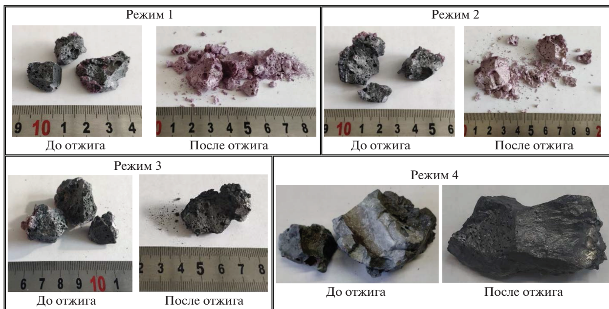
Рис. 1. Внешний вид образцов МПМ целевого состава \text{Nd}_2\text{TiZrO}_7 до и после отжига.
