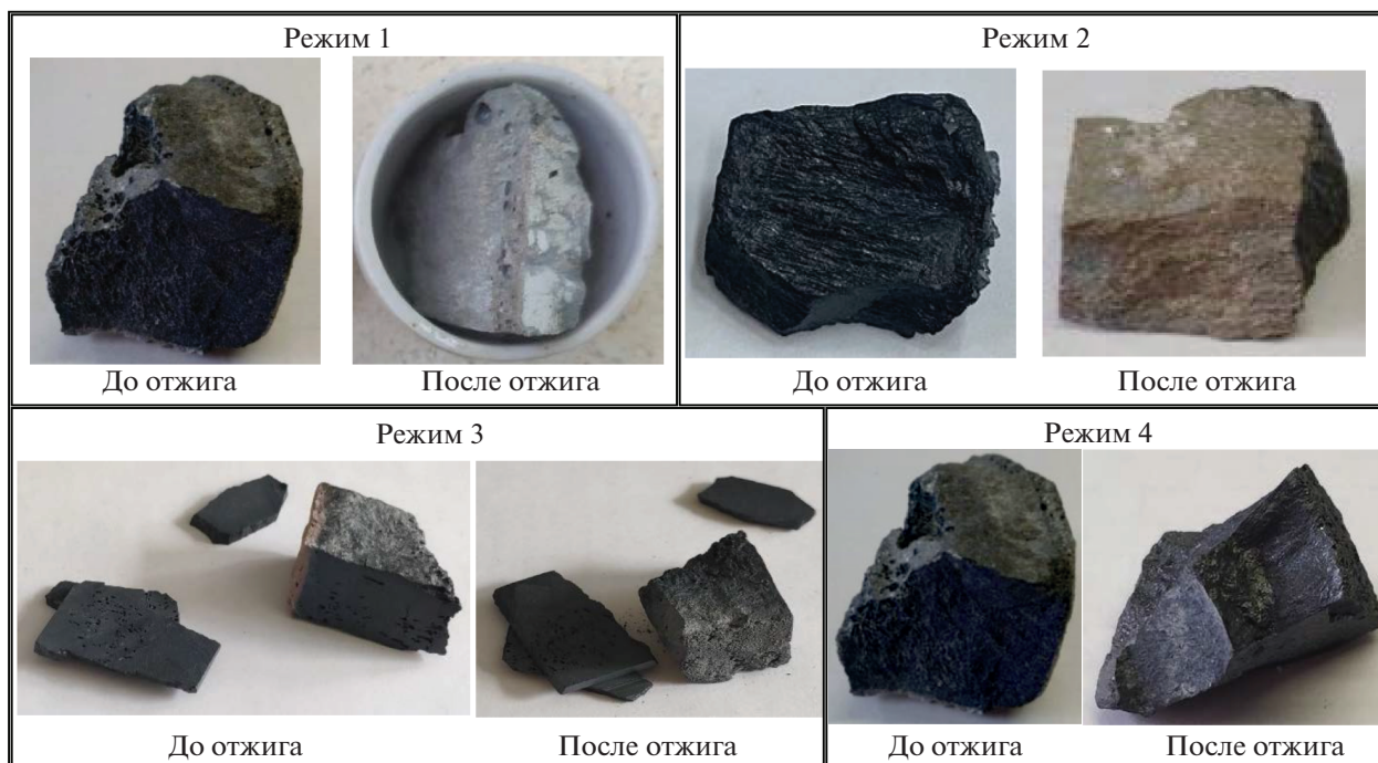
Рис. 2. Внешний вид образцов МПМ целевого состава \text{Nd}_4\text{Ti}_9\text{O}_{24} + \text{TiO}_2 до и после отжига.
