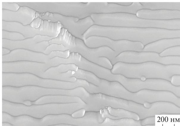
**Рис. 4.** Микроструктура поверхности синтезированного образца после ионного травления кислородом.
