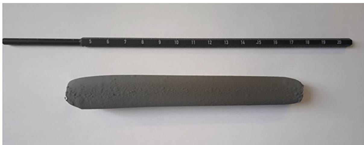
Рис. 1. Образец изотопно-обогащенного поликристаллического кремния-28.
