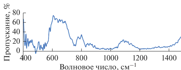
Рис. 3. ИК-спектр плава, взятого из расплава \text{CaCl}_2\text{--CaO--V}_2\text{O}_3\text{--Gd}_2\text{O}_3 .
