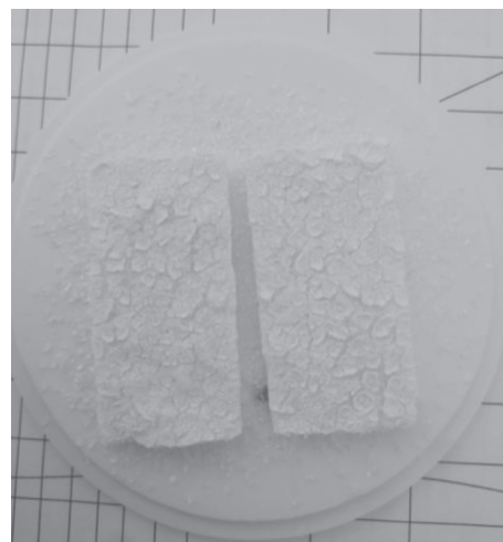
Рис. 6. Керамические образцы после обжига при температуре 1973 К.
