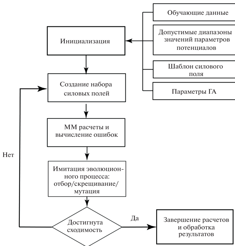
Рис. 1. Общая схема процесса оптимизации силового поля.
