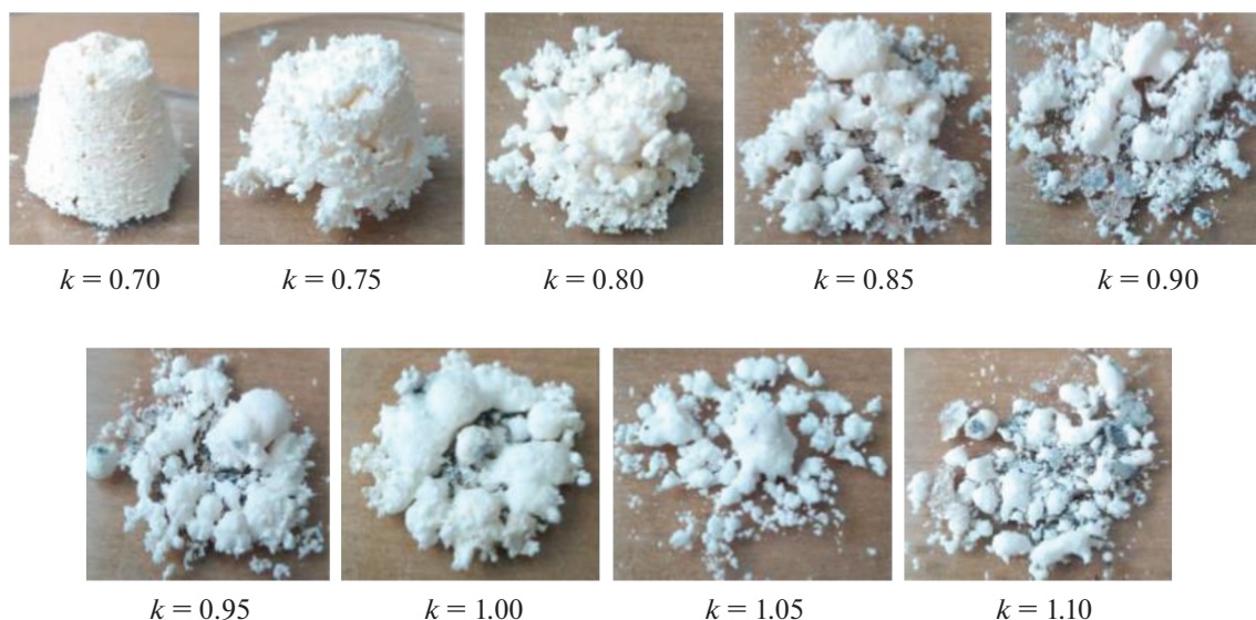
Рис. 1. Фотографии спеков образцов люминофора \text{MgAl}_2\text{O}_4 : \text{Mn}^{2+} , полученных методом СВС при значении коэффициента k , изменяющемся от 0.7 до 1.1 моль.
