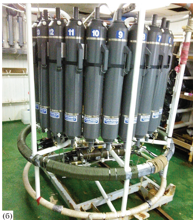
Рис. 2. LISST-Deer в судовой лаборатории в составе зондирующего комплекса SBE911plus/SBE 32/SBE32.
