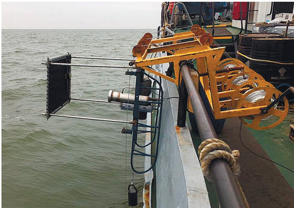
Рис. 2. Общий вид телеметрического комплекса. На борту закреплена блочная система тросов (выделена желтым цветом) для спуска-подъема платформы. За бортом погружаемая платформа с черным экраном, системой видеонаблюдения и записи.
