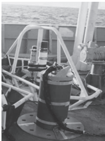
Рис. 10. Широкополосный донный сейсмограф США (Морская физическая лаборатория Скрипса) с заглубляемым в слой осадков блоком сейсмоприемников Guralp CMG-3T (на переднем плане) и размещаемом на поверхности дна блоком обнаружения и подъема [35].
