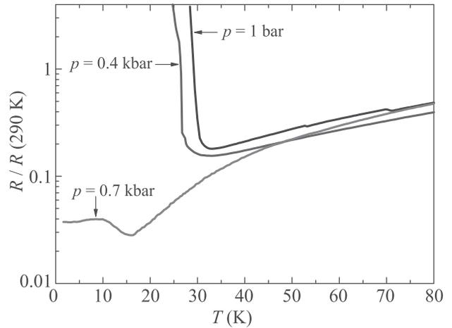
Рис. 1. (Цветной онлайн) Температурные зависимости относительного межслоевого сопротивления в  $\kappa$ -(ЕТ)<sub>2</sub>Hg(SCN)<sub>2</sub>Cl при различных давлениях
