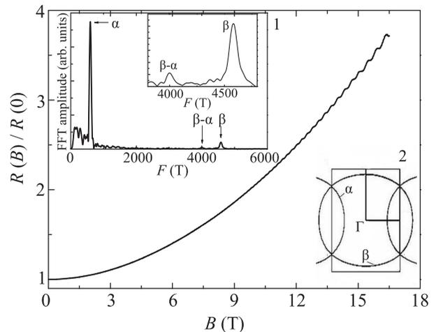
Рис. 2. Полевая зависимость межслоевого продольного магнитосопротивления в  $\kappa$ -(ЕТ)<sub>2</sub>Hg(SCN)<sub>2</sub>Cl при  $T = 0.47$  К и  $p = 0.7$  кбар. На вставке 1: Фурье-спектр осцилляций магнитосопротивления. На вставке 2: схематическое изображение поверхности Ферми в двумерных металлах  $\kappa$ -типа
