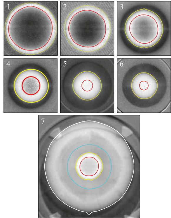
Рис. 7. (Цветной онлайн) Экспериментальные рентгенограммы: 1 –  $t = 43.00 \text{ мкс}$ ; 2 –  $t = 43.38 \text{ мкс}$ ; 3 –  $t = 43.78 \text{ мкс}$ ; 4 –  $t = 44.12 \text{ мкс}$ ; 5 –  $t = 44.44 \text{ мкс}$ ; 6 –  $t = 44.80 \text{ мкс}$ ; 7 –  $t = 44.88 \text{ мкс}$
