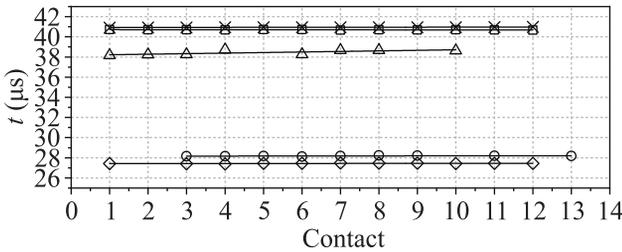
Рис. 3. Время движения ударной волны по оболочкам: ◇ –  $t_1 = (27.44 \pm 0.05)$  мкс, ○ –  $t_2 = (28.19 \pm 0.05)$  мкс, △ –  $t_3 = (38.45 \pm 0.29)$  мкс, □ –  $t_4 = (40.69 \pm 0.03)$  мкс, × –  $t_5 = (40.95 \pm 0.03)$  мкс
