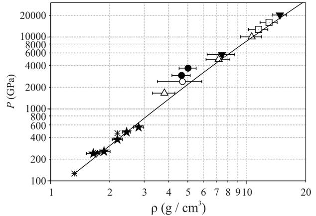
Рис. 9. Квазиизэнтропическая сжимаемость плазмы гелия в области давлений до 20 ТПа. Эксперимент:  $\blacktriangledown$  – настоящая работа;  $\triangle$  – [1, 3, 6];  $\bullet$  – [4];  $\circ$  – [9];  $\square$  – [7];  $*$  – [8];  $\star$  – [10]. Сплошная черная линия – изэнтропа  $S/R = 16$
