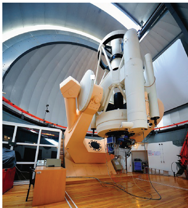
Рис. 1. Российско-Турецкий телескоп РТТ-150 с основной подвесной аппаратурой ТФОСК — спектрометр и камера для изучения слабых объектов. Диаметр главного зеркала — 1.5-м.
