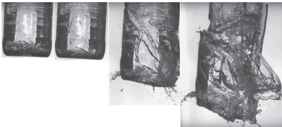
Рис. 5. Разрушение бутылки после схлопывания кавитационной полости и удара столбиком воды по днищу.
