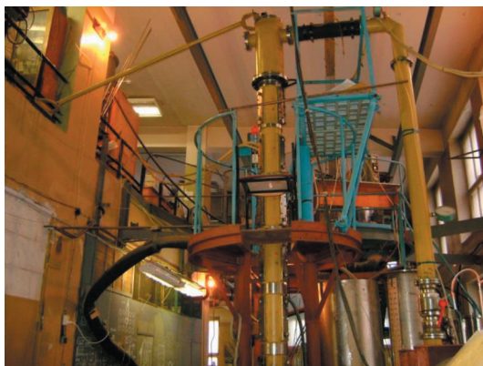
Рис. 1. Общий вид гидродинамического стенда с колонкой для размещения полномасштабных макетов ТВС ВВЭР-440.
