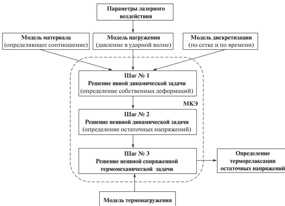
**Рис. 2.** Схема моделирования технологии ЛУВО и определения терморелаксации остаточных напряжений.
