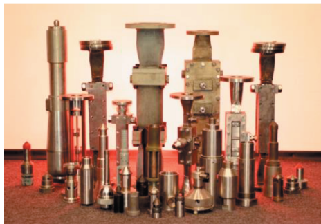
Рис. 28. Различные типы гидродинамических генераторов колебаний и волн.
