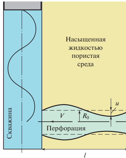
Рис. 14. Волновой резонанс на перфорационном отверстии на забое скважины. Модельная постановка.
