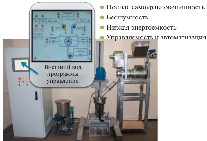
Рис. 41. Автоматизированная линия волновой обработки многофазных сред (маловязких и средневязких).
