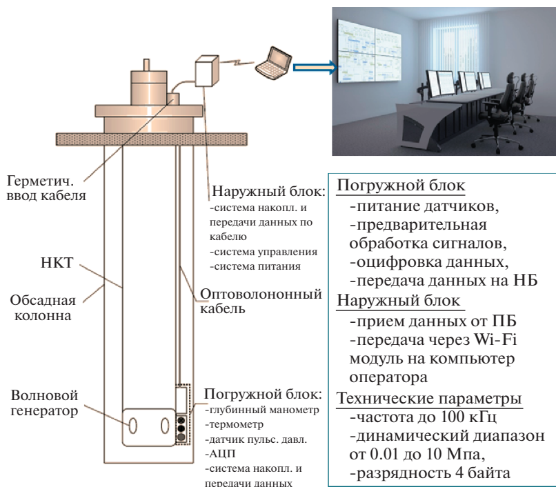
Рис. 52. Схема управляемой волновой обработки скважин.
