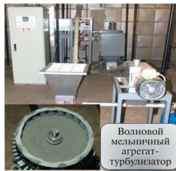
Рис. 42. Автоматизированная линия волновой обработки сыпучих материалов.
