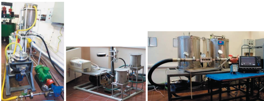
Рис. 43. Технологические линии для кавитационно-волновой обработки жидких сред (тонкое и сверхтонкое измельчение, смешение и диспергирование суспензий и эмульсий).
