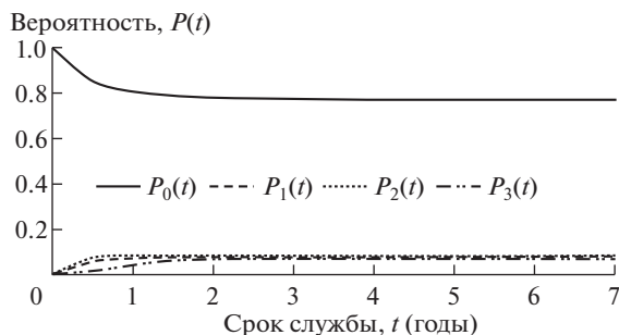
Рис. 2. Вероятность состояния системы мотор-редуктор: сценарий 1: \lambda_1 = 0.2 ; \lambda_2 = 0.3 ; \lambda_3 = 1 ; \mu_1 = 2 ; \mu_2 = 2 ; \mu_3 = 1 .
