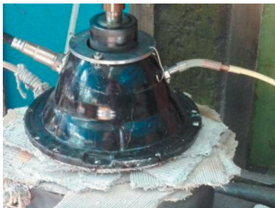
Рис. 1. Камера, в которой размещен испытательный узел.
