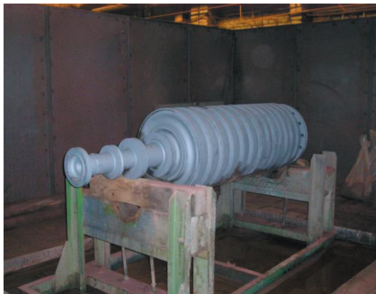
Рис. 1. Поверхность ротора паровой турбины после гидроабразивной очистки.
