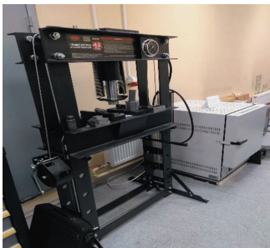
Рис. 2. Пресс гидравлический для прессования керамических порошков.
