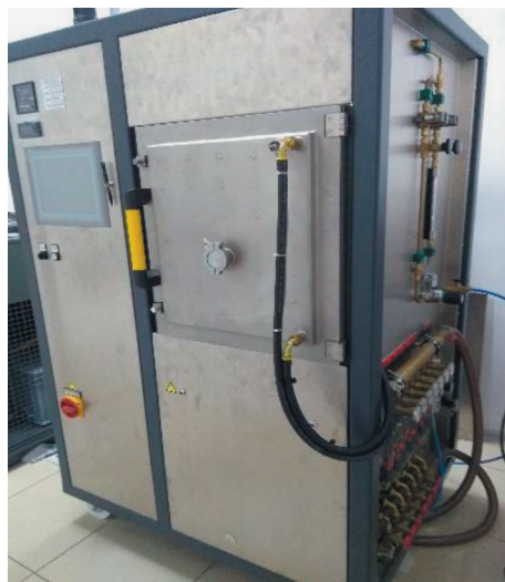
Рис. 4. Высокотемпературная печь для получения конструкционной керамики.
