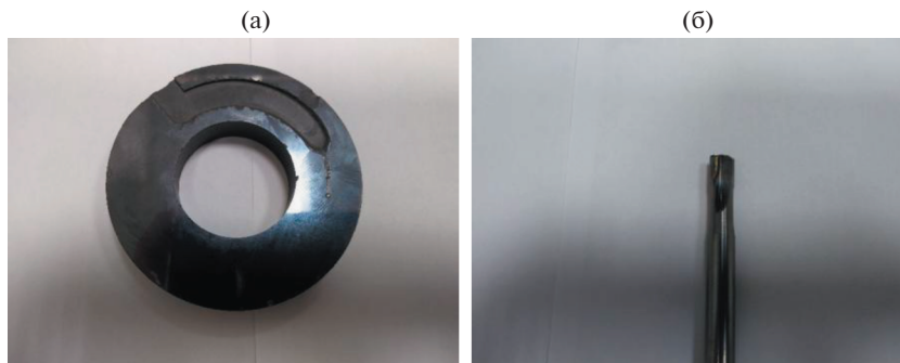
Рис. 1. Пример механической обработки высокотвердого реакционно-спеченного карбида кремния: (а) – керамическая шайба; (б) – отрыв алмазной вставки от фрезы.
