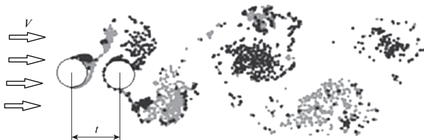
Рис. 6. Расчет срывного обтекания двух колеблющихся цилиндров методом дискретных вихрей. Анимация.
