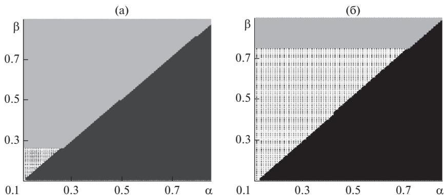
Рис. 6. Области возникновения дивергенции и флаттера на плоскости  $\alpha\beta$ : (а) – при  $\gamma = 0.25$ ; (б) – при  $\gamma = 0.75$ .
