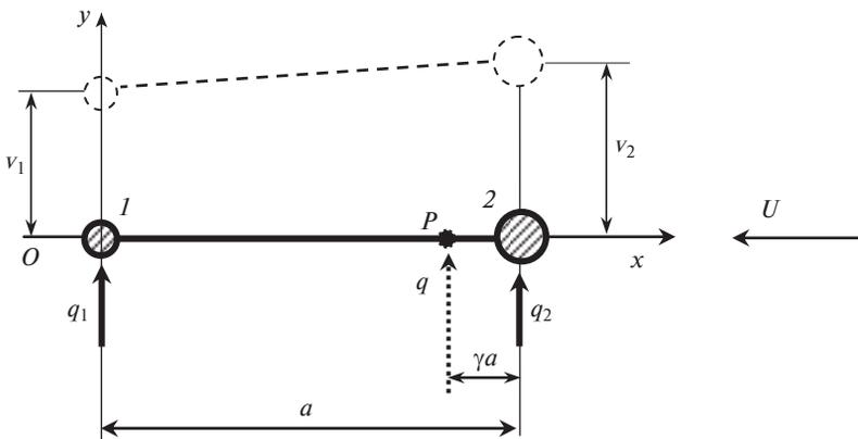
Рис. 2. Поперечное сечение расчетной схемы ленты.
