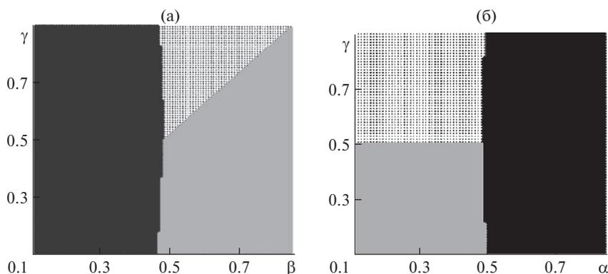
Рис. 7. Области возникновения дивергенции и флаттера: (а) – на плоскости  $\beta\gamma$  при  $\alpha = 0.5$ ; (б) – на плоскости  $\alpha\gamma$  при  $\beta = 0.5$ .
