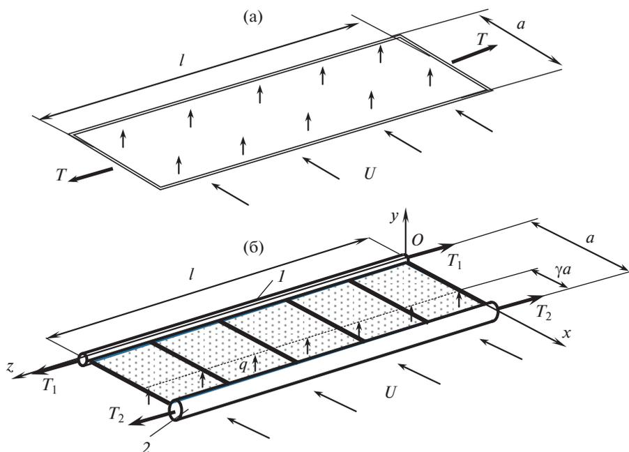
Рис. 1. Лента в воздушном потоке – (а) и ее расчетная схема – (б).
