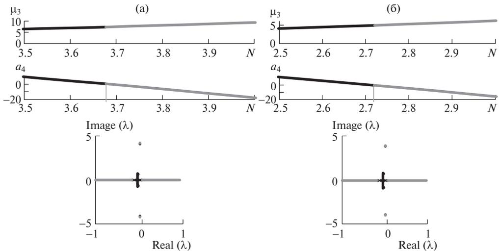
**Рис. 5.** Бифуркации Эйлера и диаграмма Аргана: (а) – при  $\alpha = 0.4; \beta = 0.6; \gamma = 0.25$ ; (б) – при  $\alpha = 0.5; \beta = 0.75; \gamma = 0.25$ .
