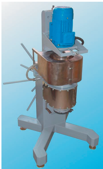
Рис. 1. Экспериментальная установка волнового смешивания VM-58.
