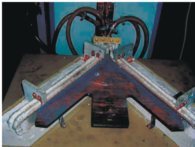
Рис. 5. Заготовка стрелчатой лапы “Алтай”, установленная в индуктор с двумя параллельными ветвями. Состав для создания борирующего покрытия на стали 65Г содержал 80% карбида бора и 20% – флюса.
