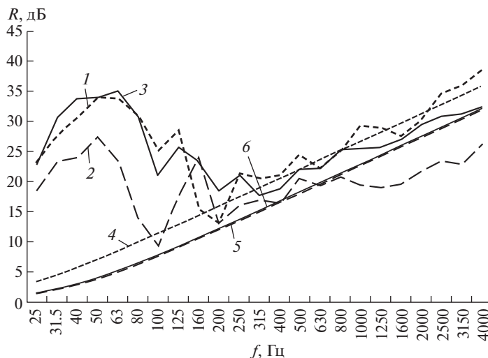
Рис. 2. Осредненные по временным диапазонам характеристики звукоизоляции исследуемых панелей: 1 – образец 1, эксперимент; 2 – образец 2, эксперимент; 3 – образец 3, эксперимент; 4 – образец 1, расчет по ЗМ; 5 – образец 2, расчет по ЗМ; 6 – образец 3, расчет по ЗМ.
