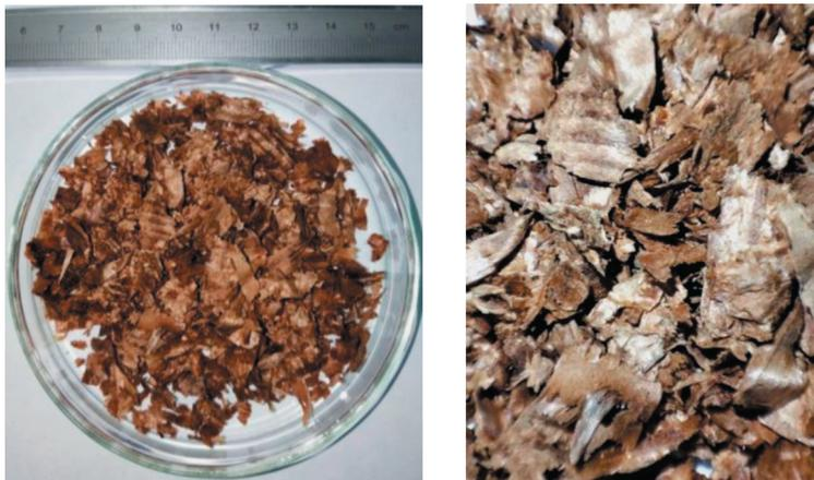
Рис. 2. Фотографии древесной стружки после автогидролиза при 220°C, 2,3 МПа, 1 мин.
