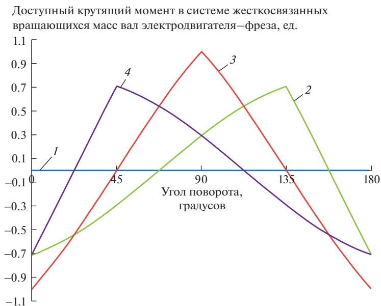
Рис. 3. Влияние разницы положения по углу поворота максимумов кривой генерации и потребления крутящего момента на величину суммарного доступного крутящего момента: 1 – при угле 0°; 2 – при угле 45°; 3 – при угле 90°; 4 – при угле 135°.
