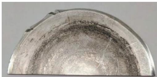
**Рис. 2.** Заготовка сплава АМг2 после осадки с кручением.
