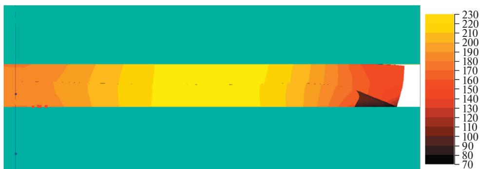
Рис. 7. Распределение температуры в заготовке из АМг6 после осадки с кручением.
