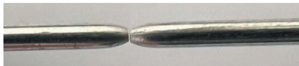
Рис. 3. Вид шейки образца на растяжение перед разрушением.
