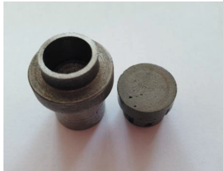
Рис. 7. Вид контробразца из чугуна и образца из металлополимера после 2 \times 10^6 циклов испытаний.
