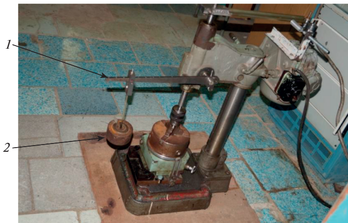
Рис. 1. Общий вид модельной установки: 1 – рычаг нагрузки; 2 – грузы.
