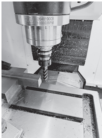
Рис. 2. Процесс обработки поверхности боковой частью концевой фрезы.
