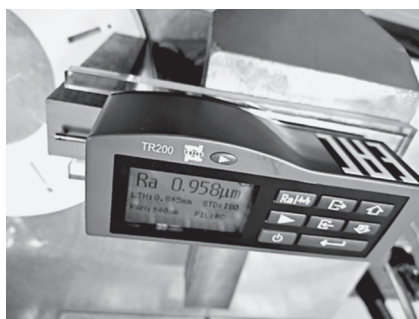
Рис. 3. Измерение шероховатости профилометром мод. TR200.
