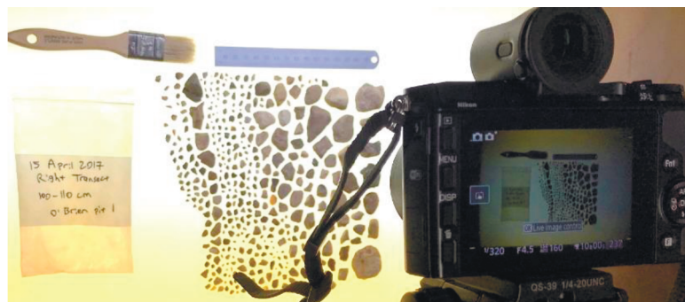
Рис. 2. Цифровая фотосъемка грубых обломков, извлеченных из почвенного образца.
