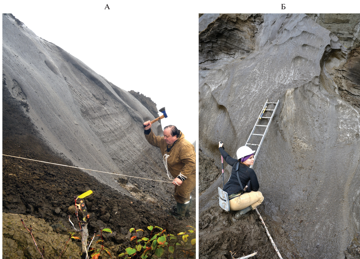
Рис. 1. Детально отобранные образцы из ледяных жил в обнажении Батагайской едомы: жила 3 в верхней части разреза (А) и жила 2 в нижней части разреза (Б). Фото Ю.К. Васильчука.
