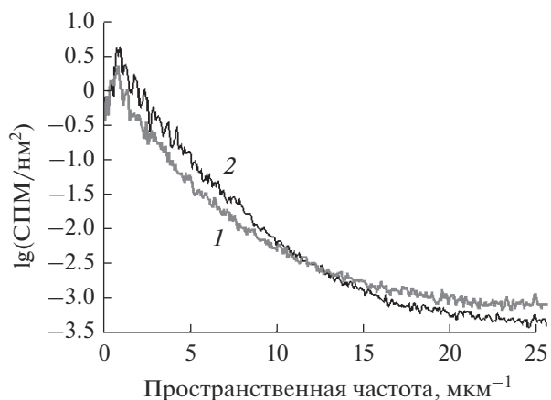
Рис. 3. Вертикальные функции СПМ исходной поверхности зеркала Mo (111) (1) и поверхности, экспонированной в плазме D_2-N_2 в течение 16 ч (2).
