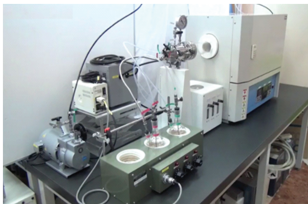
Рис. 1. CVD-прибор, используемый для синтеза УНТ.
