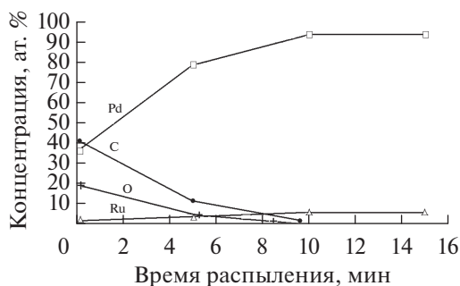
Рис. 2. Профили концентраций химических элементов, входящих в состав пленок Pd–Ru(7 ат. %), полученных методом магнетронного распыления.
