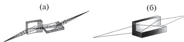
Рис. 2. Схема классической (а) и конфокальной (б) оптических систем Киркпатрика–Баеза.
