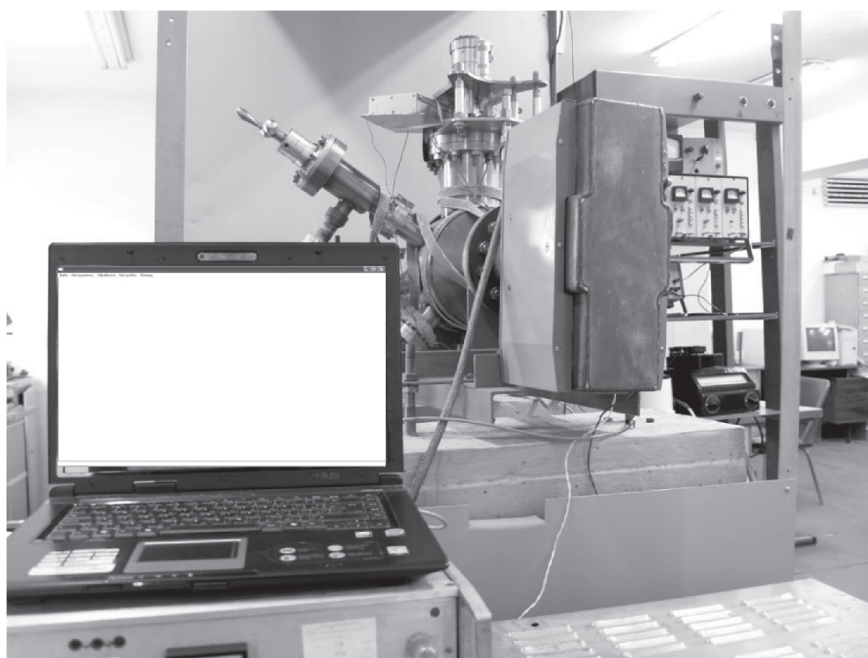
Рис. 3. Экспериментальная установка для получения дифракционных картин. (а) – структура экспериментальной установки, (б) – общий вид экспериментальной установки.
