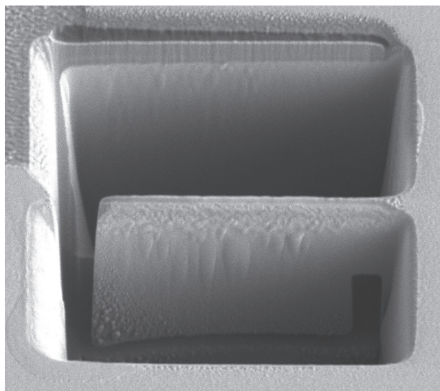
Рис. 13. Изображение подготовленной ламели до перенесения на сетку для ПЭМ.
